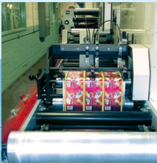
MPS EP510 machine d'impression 1 chez Townsend, impression sur PET 40 µm. Macchina da stampa MPS EP510 No. 1 installata presso la Townsend, durante la stampa di PET da 40 micron.
