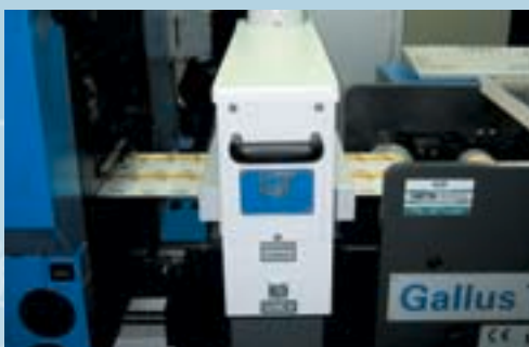
Un des 28 modules de lampe IST UV dans les machines d'impression Gallus. Uno dei 28 forni IST UV installati sulla linea Gallus.
