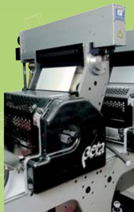
Edale Beta, machine d'impression flexo avec des modules des lampes IST. Macchina flexo Beta della Edale con moduli lampada IST.
